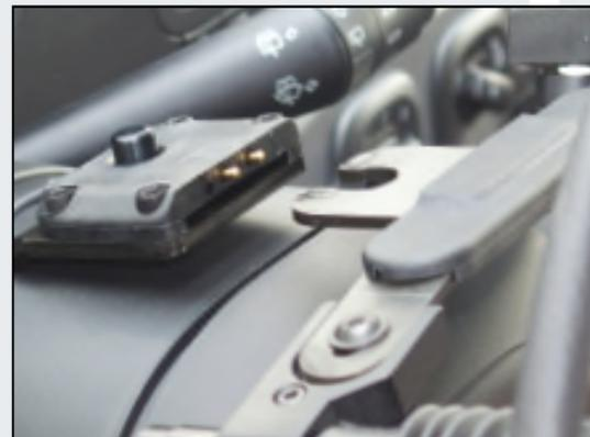
**D916R** Acceleratore elettronico rotativo sotto il volante
