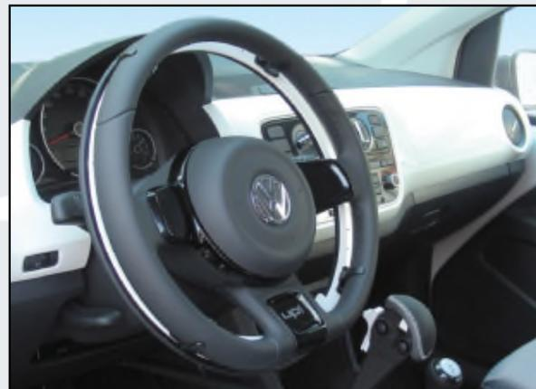
**D906A Acceleratore meccanico a cerchiello posto sopra il volante**
