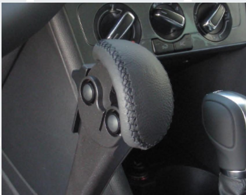
**2015A Monoleva con acceleratore a levetta**
