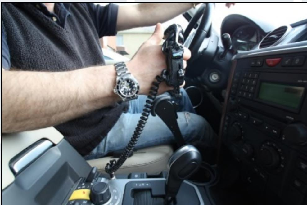
**AC2002** Acceleratore elettronico a cerchiello sopra al volante
