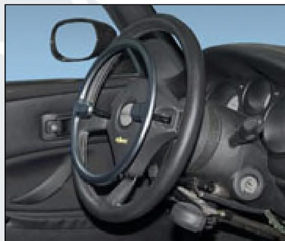
**D916GV Acceleratore elettronico a cerchiello posto sotto il volante originale**
