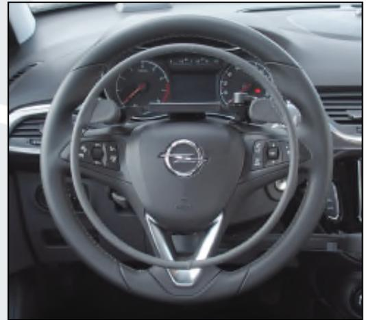
**D906GVQR** Acceleratore elettronico a cerchiello sfilabile «Quick Release»
